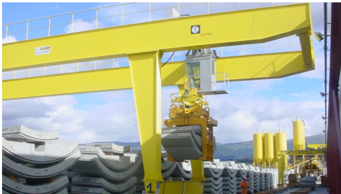
Parque de dovelas. Túneles de Guadarrama (FCC)
